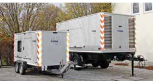
Mit der Neuanschaffung von zwei mobilen Notstromaggregaten mit 200 kW und 400 kW Leistung als Ersatz für die 25 Jahre alten stationären Aggregate auf dem Werksgelände
