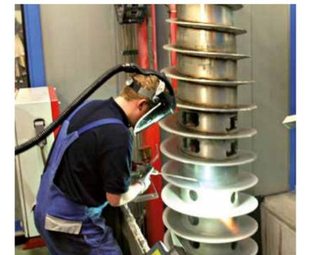
Operation am offenen Herzen. Schweißarbeiten an einer Dekanterschnecke
